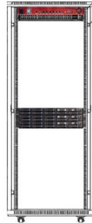
Rack - voll ausgelastet bei 5 kW auf 3 HE (GPU Server)
